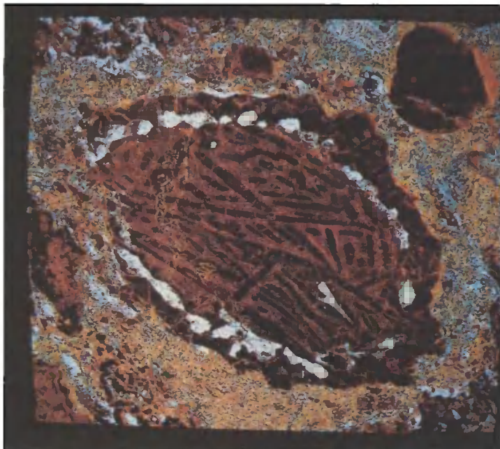
Минеральный состав хондры из метеорита Ефремовка. Основная часть хондры (центральная область снимка) представлена аморфитом и оливином, периферийная — сульфидами. Это и другие изображения получены в пучке отраженных электронов с последующим кодированием условными цветами. Снимки сделаны с растрового дисплея электронного микроскопа лаборатории электронной микроскопии и микроанализа геологического факультета МГУ.
