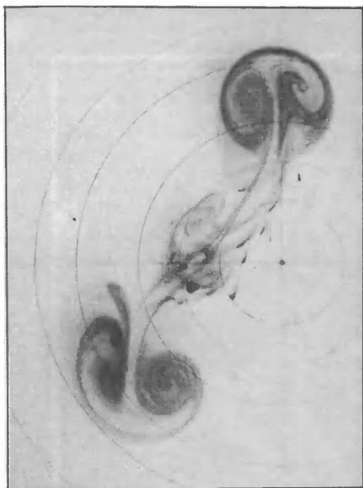
Пара вихревых диполей, сформировавшихся во вращающемся однородном слое жидкости толщиной 4 см из турбулентного облака, образованного локальным антициклоническим закручиванием в течение 6 секунд с помощью лопасти. [Эксперимент А. И. Гинзбург, А. Г. Костяного, А. М. Павлова, К. Н. Федорова, ИОАН.]
